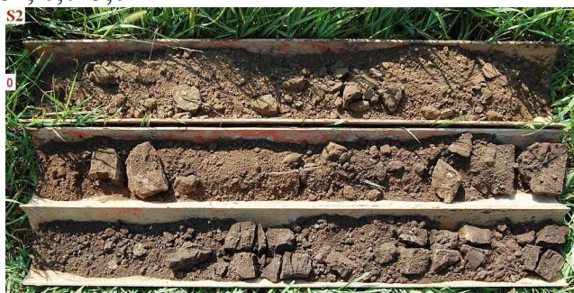
Obrázek č. 2 Sonda S2, 0,0–3,0 m
